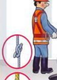
ЗАПРЕЩАЕТСЯ использовать стальной канат, сплошной узел или пинцеты с обработанной прядью
