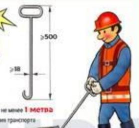
Снятую крышку люка сдвигают на расстояние не менее 1 метра от кромки горловины колодца по ходу движения транспорта
