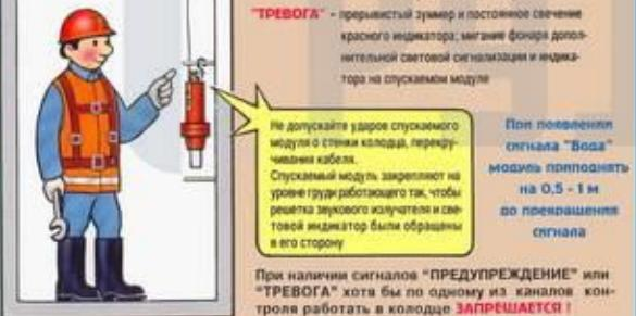
При появлении сигнала "Вода" модуль приподнять на 0,5 - 1 м до прекращения сигнала
